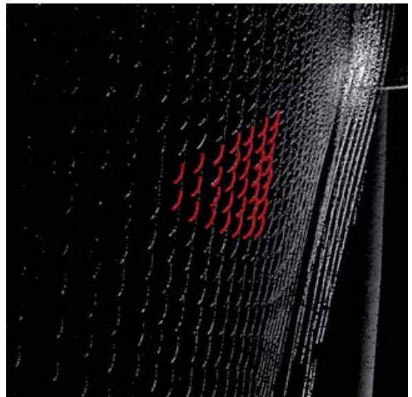
Ausschnitt aus einer Punktwolke von einem 3D-Scan, in Rot werden einzelne Profile hervorgehoben
