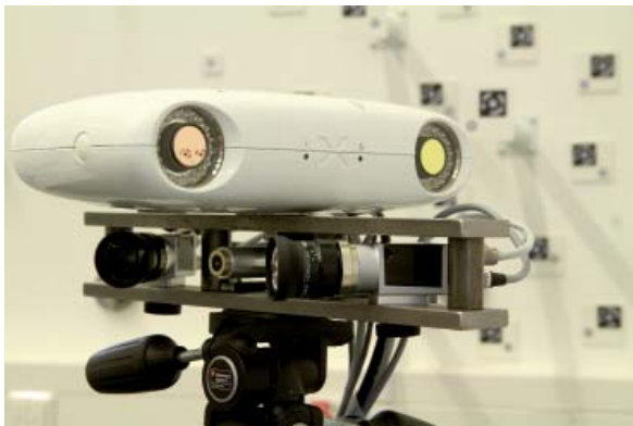
Aktueller Messkopf; oberes Stereokamerasystem (AXIOS 3D Services GmbH) dient der Navigation, unteres Stereokamerasystem (Basler AG) sowie Laserlinienmodul dient der Oberflächenerfassung
