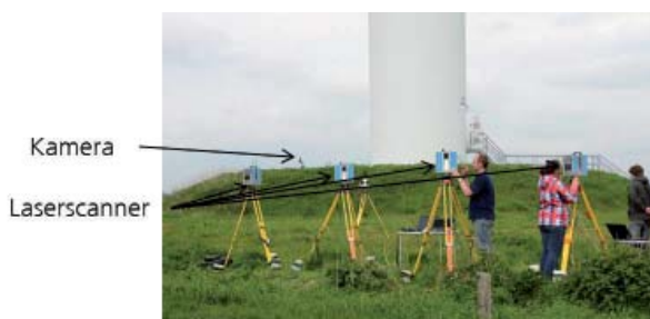
Messaufbau an einer Windenergieanlage
