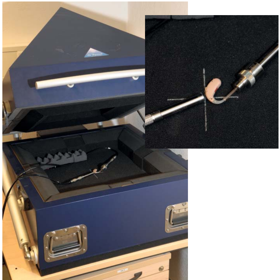
Messbox zur Messung der akustischen Eigenschaften von Hörgeräten
