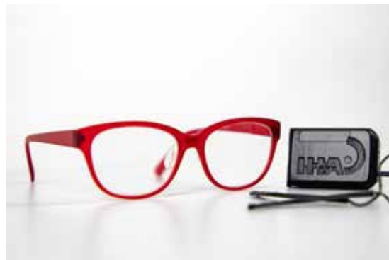
Abbildung 1: olMEGA. Das EMA-System bestehend aus Smartphone, Bluetooth-Transmitter und Mikrofonen wurde am IHA entwickelt. Die Mikrofone lassen sich einfach an Brillenbügeln befestigen und entfernen.
