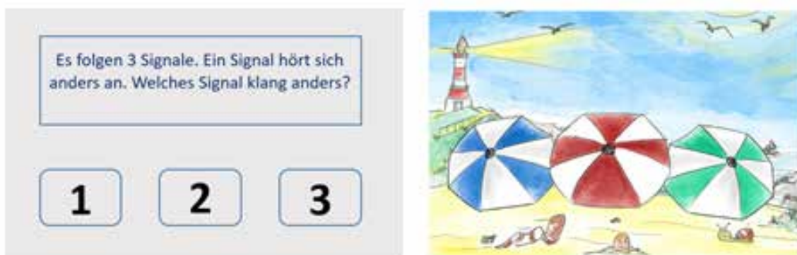
Abbildung 1: Bedienoberfläche (GUI) eines 3-Alternative forced choice (AFC) Antwortverfahrens, welches im PLOBI2go Projekt verwendet wird. Links ist eine herkömmliche Version dargestellt und rechts der Entwurf einer kindgerechten, animierten Methode. [K. Schmidt, Jade HS]
