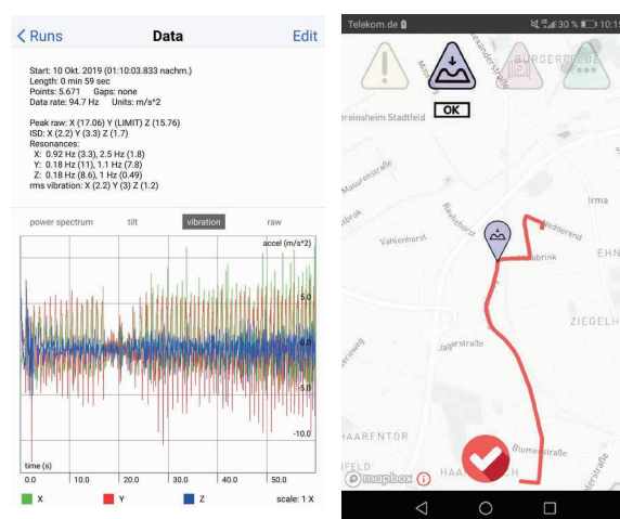
Vibrationsdaten eines Mobiltelefons (links), Ansicht aus der CycleTraQ App (rechts)
