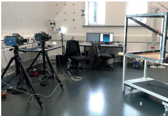
Kamerakonfiguration mit einem Testkörper nach VDI 2634.1
